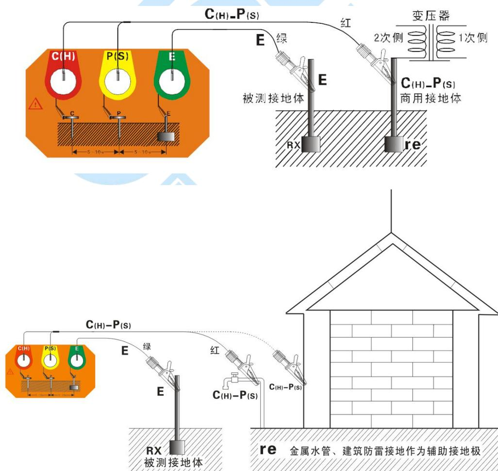
简易法测量接地电阻，其仪表读数为被测接地体的接地电阻值与商用接地体的接地电阻值之和，即：
