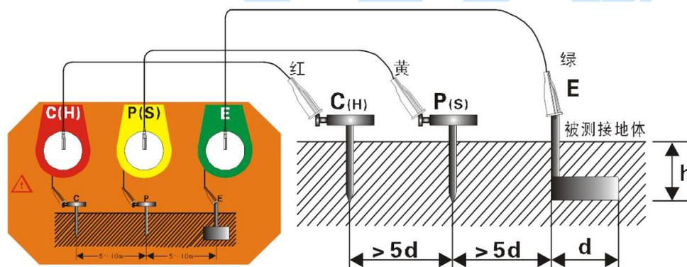
连接好测试线后，先将 **FUNCTION** 功能选择旋钮旋至 “**REARTH**” 位置，进入接地电阻测试模式，按一下 “**TEST**” 键开始测试，测试过程中有倒计时指示及测试进度棒图指示，测试完毕后显示稳定的数据，即被测接地体的接地电阻值 R。
